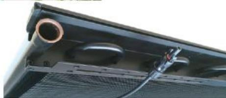
PVT Kollektoren – **PhotovoltaikThermie** – nutzen sowohl die Oberseite – zur Stromgewinnung – als auch die Unterseite – als Wärmequelle – eines Kollektors. Auf der Oberseite befindet sich 2,25 m<sup>2</sup> PV und auf der Unterseite 19 m<sup>2</sup> Oberfläche für einen Luftwärmetauscher, der diese Wärme der Wärmepumpe zu führt. Diese wärmeabfuhr kühlt die Oberseite und dies verbessert die Stromausbeute um bis zu 10%.
