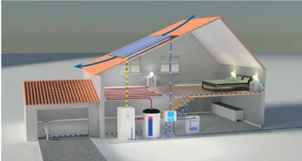
Schematische Darstellung eines möglichen Aufbaus mit Wärmepumpe und PVT-Kollektoren.
