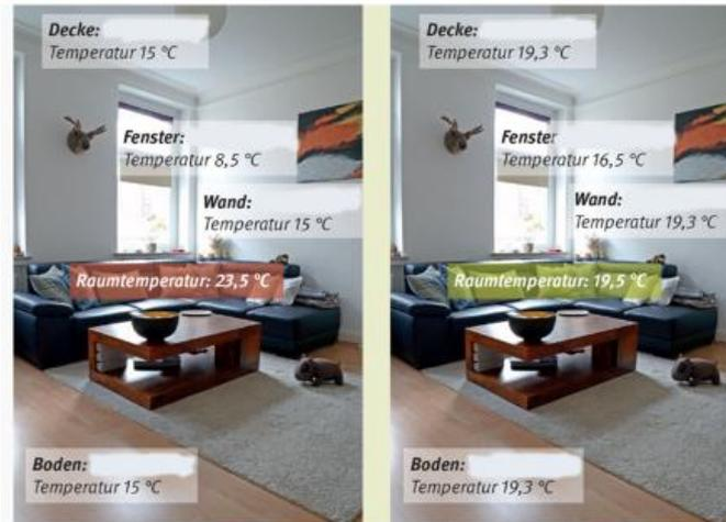
Linkes Bild: rel. hohe Raumtemperatur, starke innere Zugserscheinungen. Denn die warme Luft bewegt sich ständig in Richtung der kälteren Oberflächen, die Wärme verlässt den Bereich, den mensch eigentlich warm haben möchte. Ab einem Temperaturunterschied von mehr als drei Grad bemerken wir diesen Luftstrom: „Es kommt kalt rein“ oder „es zieht“ heißt es dann. Folge: Behaglichkeit, sich wohlfühlen will sich nicht einstellen.
